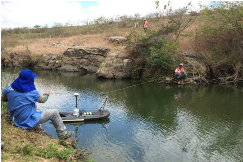
Monitoramento quantitativo (medidor de vazão acústico M9)
