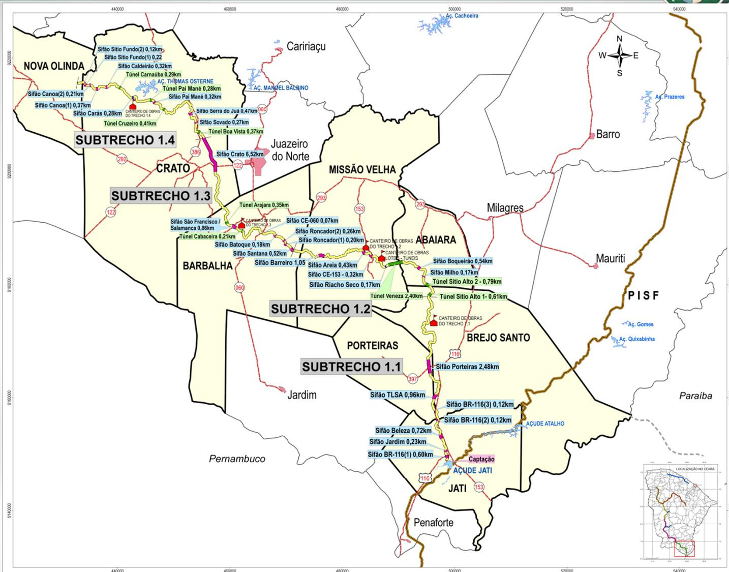
Trecho 1 – totalmente gravitatório, com início na tomada d'água na barragem Jati, onde haverá a captação das vazões transpostas pelo Projeto PISF. Esse trecho tem extensão total de **145,3 km**, terminando na travessia do rio Cariús, com vazão máxima de **30 m<sup>3</sup>/s**
