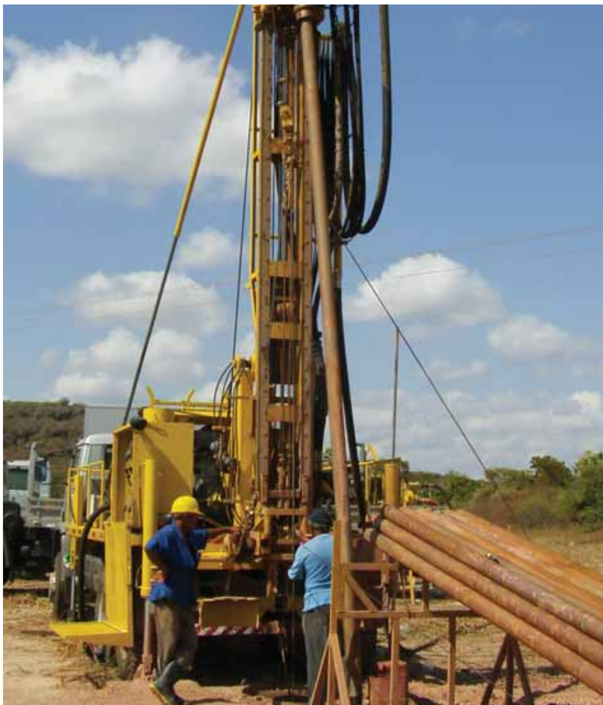
Máquina apropriada para perfuração de poços em rochas cristalinas
