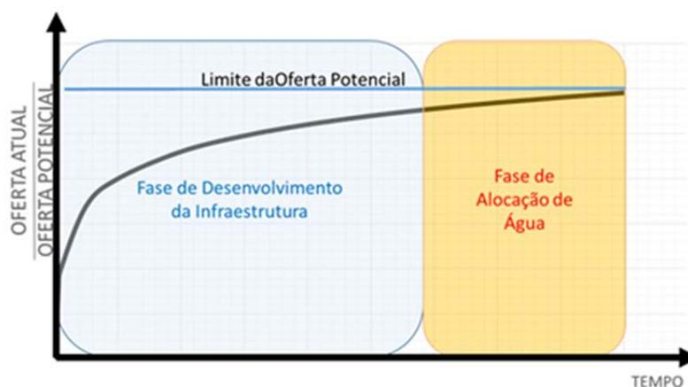
**Figura 4.1 - Evolução da ativação do potencial hídrico em uma bacia**
