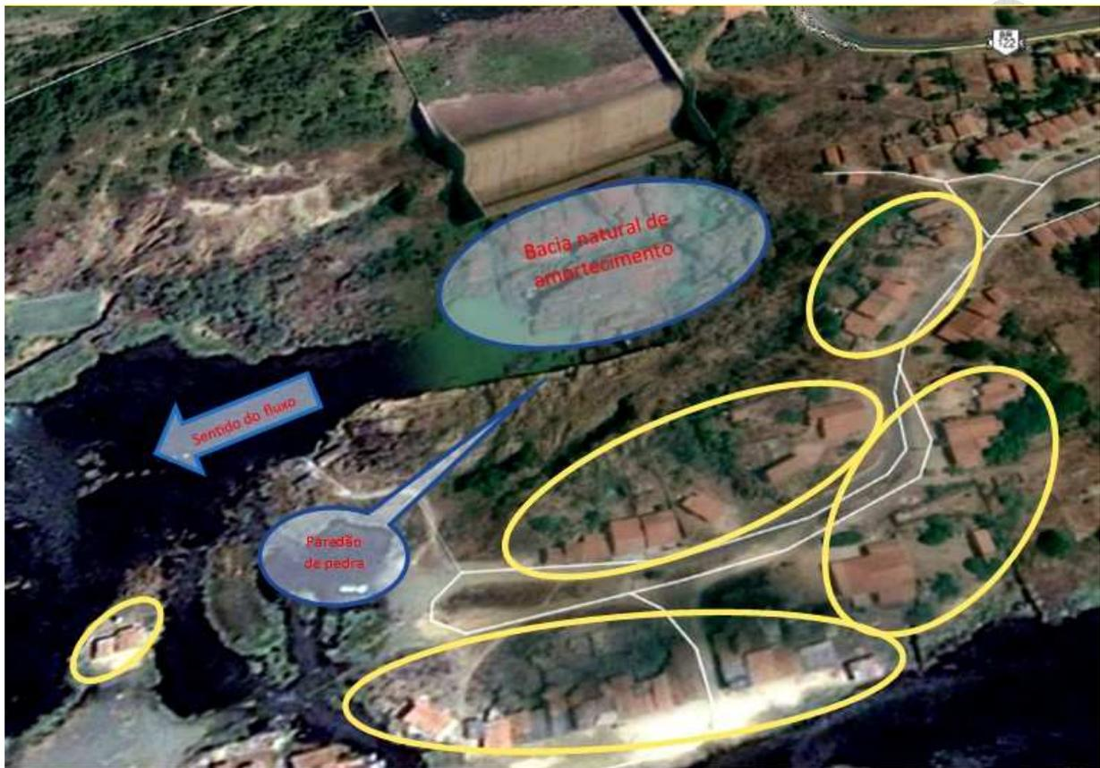
A barragem ao extravasar verte a água numa bacia natural de amortecimento e o seu fluxo é re-direcionado por uma barreira natural (paredão em pedra) entre as edificações e a barragem. Apenas o estudo de segurança de barragem, incluindo PAE – Plano de Ação Emergencial poderão indicar a necessidade, ou não, de relocação das edificações existentes.
