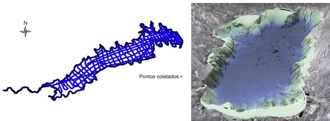
Os Levantamentos Batimétricos são importantes para se determinar a tabela Cota-Área-Volume (CAV) atual em cada reservatório, e através desta, podemos conhecer o volume armazenado em função do nível da água.
