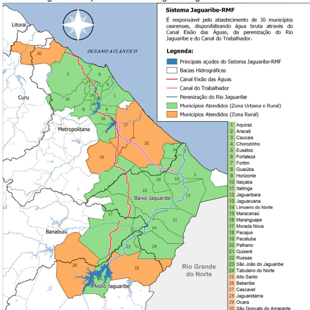
Em 2021, o Sistema Integrado Jaguaribe - RMF contou com o aporte das águas oriundas do Projeto de Integração do Rio São Francisco (PISF), esta transferência hídrica ocorreu através do canal adutor do Eixo Norte, e de parte concluída das obras do Cinturão das Águas do Ceará-CAC. (Figura 6)
